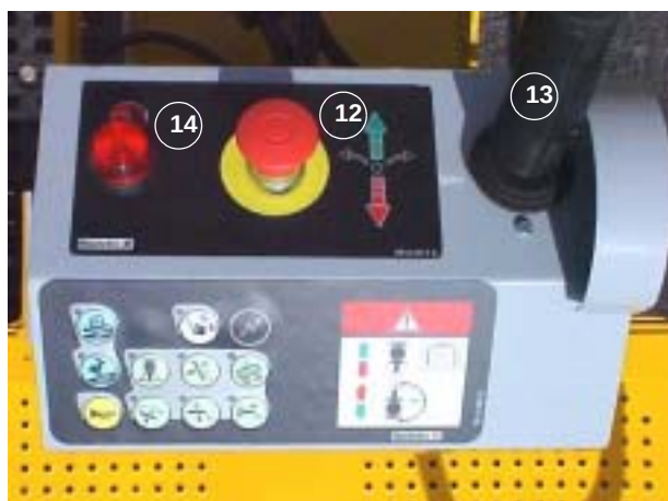
Foto 5: Puesto de mando barquilla
